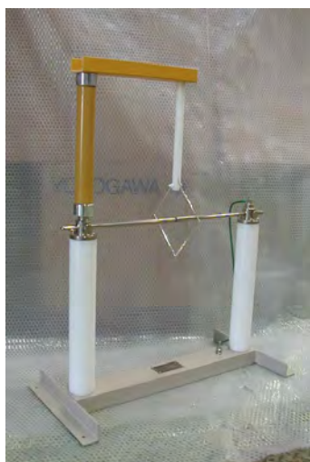
写真 14: 沿面放電装置 電極装置
