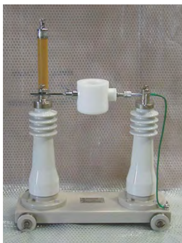
写真 9: 絶縁油試験器（オイルカップ付）
