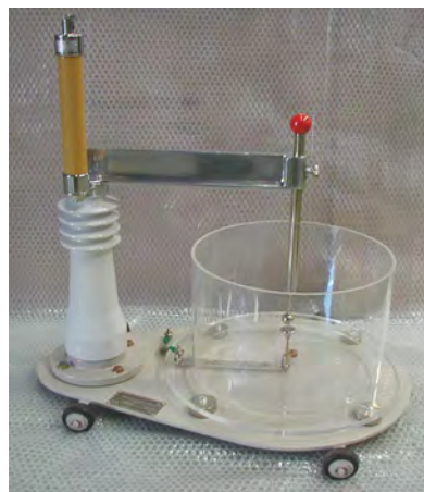
写真 10: 絶縁油中耐压試験器
