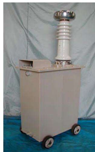
写真 12: 100kV 試験用変圧器
