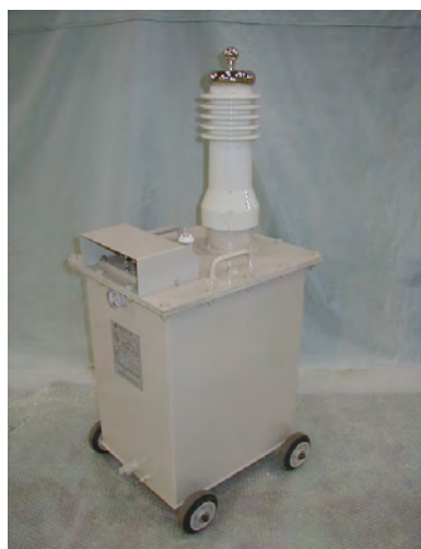
写真 11: 50kV 試験用変圧器
